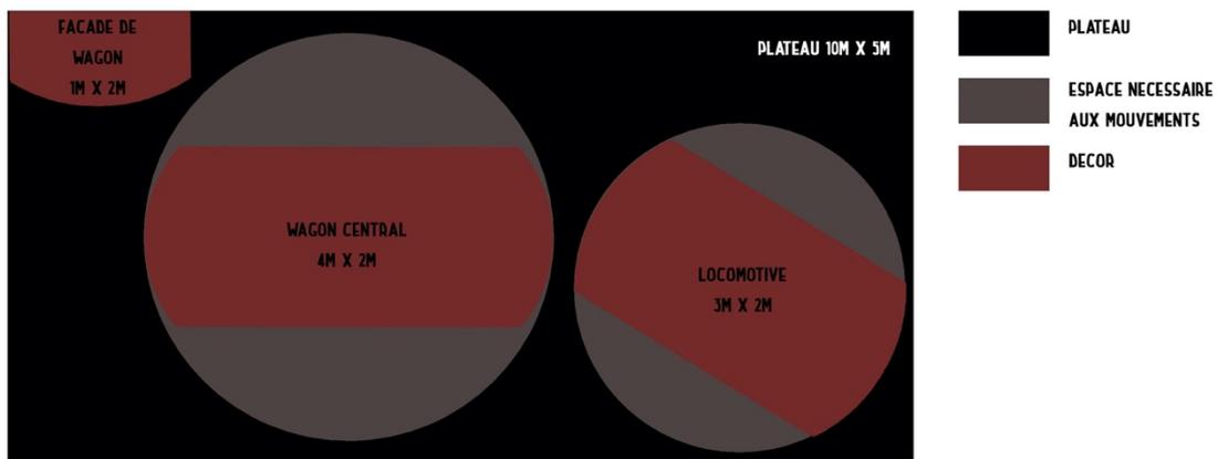
Le wagon central ainsi que la locomotive seront positionnés sur des structures leur permettant de tourner sur eux-mêmes, dévoilant par exemple l'extérieur puis l'intérieur du wagon.
